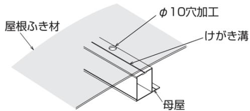
3 スペースのハクリ紙をはがし、加工穴にあわせて屋根ふき材と母屋の間に取り付けてください。
