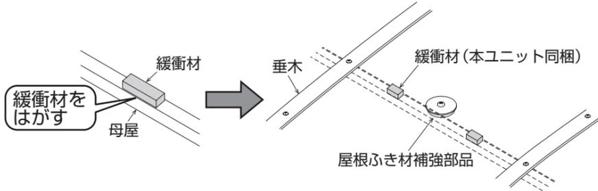
2 屋根ふき材補強部品の取り付け位置に、穴中心が母屋のケガキ溝にあうように、穴加工（φ10）してください。穴加工後の切削屑は除去してください。
